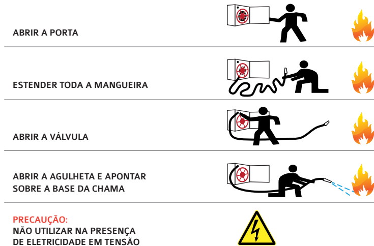
FIGURA 29 Esquema com o modo de utilizar uma boca-de-incêndio armada do tipo teatro.
